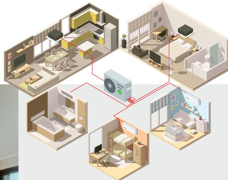
Řešení multi split jednotek nabízí velkou flexibilitu, protože k jedné venkovní jednotce lze připojit 2 až 5 vnitřních jednotek. Široká nabídka kompatibilních vnitřních jednotek zahrnuje nástěnné jednotky Etherea a TZ i parapetní, 4cestné kazetové 60 × 60 a kanálové jednotky s nízkým statickým tlakem.
