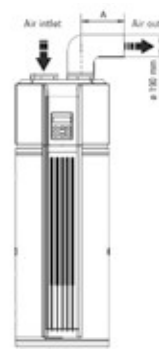
3 Výstup napojený na potrubí
