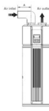
2 Vstup napojený na potrubí
